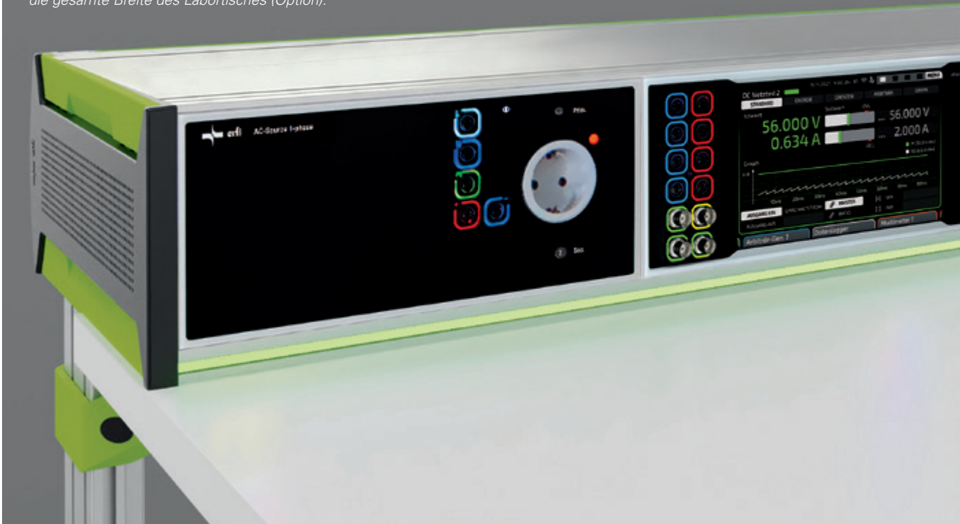
Abbildung 3, Detailansicht: Tischbeispiel mit 19-Zoll-Tischaufbau aus Aluminium 3 HE. Bautiefe 2 = 360 mm. Seitliches Funktionselement in grün, RAL DESIGN 1107070. Integriertes RGB-Indikationslicht oben und frontseitig über die gesamte Breite des Labortisches (Option).
