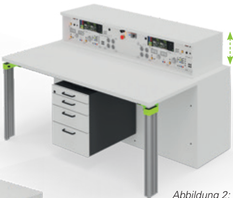
Abbildung 2: Tisch mit 19-Zoll/6 HE-Versenkeinheit , Tischbreite 1800 mm. Arbeitsplatte ergo-line mit Laserkante.
